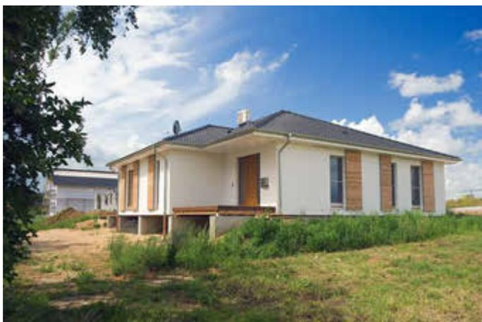
Holzmodulhäuser werden auf Streifen- oder Punktfundamenten errichtet. Eine vollflächige Bodenversiegelung wird dadurch vermieden. Foto: [djd/www.smart-house.com/RecordTeam](http://djd/www.smart-house.com/RecordTeam)
